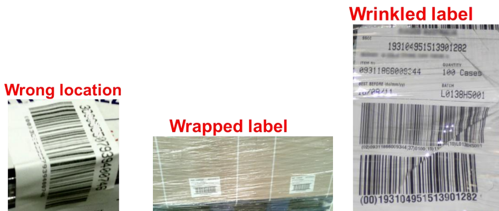
Figuur 9.4: voorbeelden van problemen met de plaatsing
