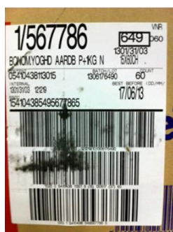
Figuur 9.3: voorbeelden van problemen met afdrukken
