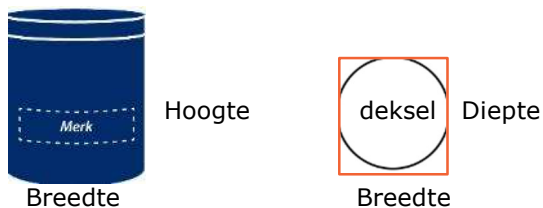
Figuur 2.2: voorbeeld van hoe een cilindrische of niet-reguliere vorm te meten
